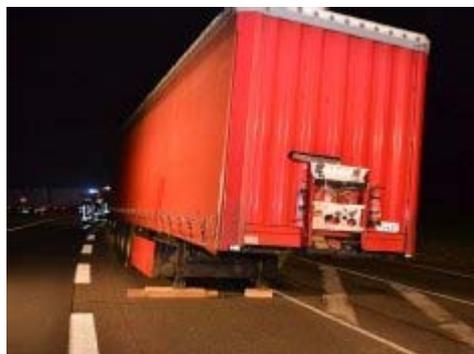
Um die Fässer mit Gefahrgut zu sichern, wurde der Anhänger mit Holzbrettern abgestützt.
